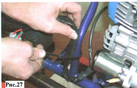
**3.8.5** ЗАКРЕПИТЕ АККУМУЛЯТОРНУЮ БАТАРЕЮ И НАКОНЕЧНИКИ ПРОВОДОВ С ПОМОЩЬЮ СКОБЫ (СМ. РИС. 28).
