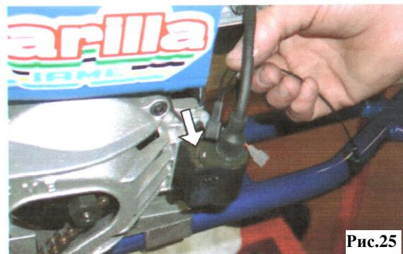
**3.8.3** ПОДСОЕДИНИТЕ НАКОНЕЧНИК ВТОРОГО ПРОВОДА К ОХВАТЫВАЕМОМУ СОЕДИНЕНИЮ ПРОВОДКИ (СМ. РИС. 26).
