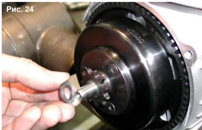
**g) ВСТАВЬТЕ ФИКСАТОР ПОРШНЯ, ЧТОБЫ ПРЕДОТВРАТИТЬ ПОВОРАЧИВАНИЕ ВАЛА (см. рис. 25), И ЗАТЯНИТЕ ГАЙКУ М10 НА БАРАБАНЕ.**
