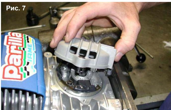
**4. ДЕМОНТАЖ ЗАЖИГАНИЯ:**
